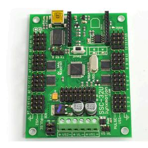
Questa disposizione logica facilita il l'organizzazione cablaggio e collegamenti. La scheda richiede due tipi di tensione per il funzionamento ottimale: una per la parte logica (VL) e una per alimentare i servomotori (VS1 per i servomotori da 0 a 15 e VS2 per quelli da 16 a 31). Questa suddivisione dell'alimentazione consente gestione efficiente dell'energia e una flessibilità maggiore nell'implementazione dei progetti. Per la
