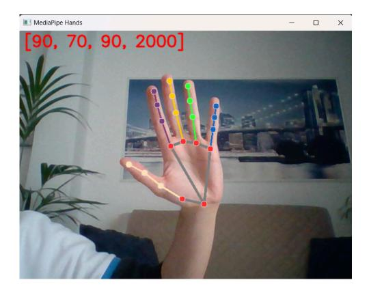
In alto a sinistra vengono mostrati gli angoli dei servomotori in tempo reale: base, spalla, gomito. Il quarto dato si riferisce allo stato della pinza, 2000 equivale ad aperta e 1500 a chiusa.
