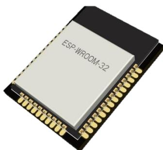
Inoltre, l'ESP32 WROOM 32 offre una serie di funzionalità avanzate, come una vasta gamma di porte di input/output (I/O), che consentono il collegamento di sensori e dispositivi esterni per l'acquisizione dei dati ambientali. Questo permette al dispositivo di essere altamente personalizzabile e adattabile alle esigenze specifiche del progetto.
