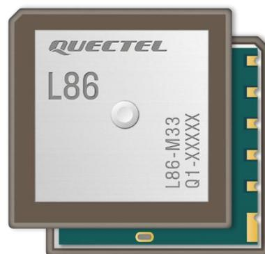
Inoltre, il Quectel L86 offre una bassa potenza di funzionamento, consentendo un utilizzo prolungato senza esaurire rapidamente la batteria del dispositivo. Questo lo rende particolarmente adatto per dispositivi portatili, ottimale nel mio caso. In aggiunta è in grado di fornire l'ora e la data esatta, in modo tale da poter interfacciarlo alle periferiche esterne, ad esempio il Display LCD.
