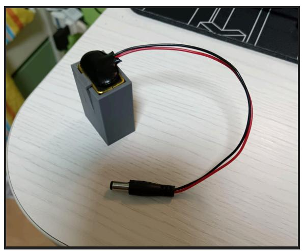
Ho infine creato la struttura per mantenere il sensore HC SR04 fisso ad una pendenza di 45° a pochi centimetri dalla fine dell'asta, così da avere un puntamento preciso e stabile durante l'utilizzo.
