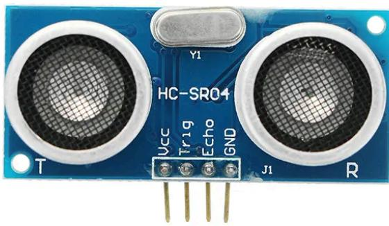
Il sensore ad ultrasuoni HC-SR04 è un dispositivo utilizzato per misurare la distanza tra il sensore stesso e un oggetto. Funziona emettendo un impulso di ultrasuoni (onde sonore ad alta frequenza che non sono udibili dall'orecchio umano) e misurando il tempo che intercorre tra l'emissione dell'impulso e il ritorno dell'eco dopo aver rimbalzato sull'oggetto.
