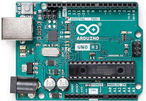
Arduino Uno R3 è una scheda di sviluppo open-source basata sul microcontrollore ATmega328P. È uno dei modelli più popolari di Arduino e viene ampiamente utilizzato per progetti di elettronica e di prototipazione. Alcune delle caratteristiche principali di Arduino Uno R3 includono:
