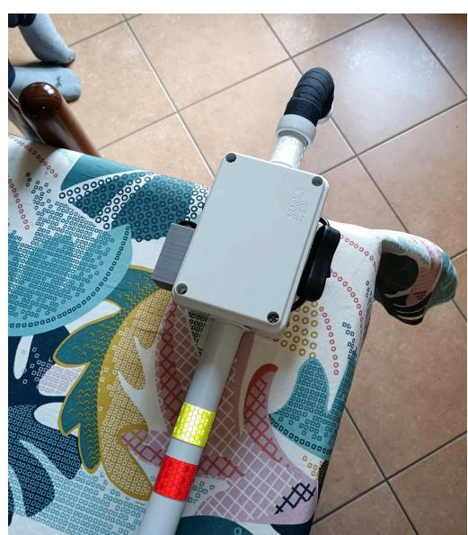
Per un fattore di comodità ho inserito nel progetto uno switch, che posto tra la batteria da 9v e l'entrata dell'alimentazione del circuito, da la possibilità a chi ne fa uso di poter accendere e spegnere il dispositivo in qualsiasi momento in modo rapido.
